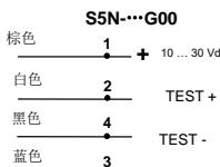
\* 如果白色线缆或引脚 2 未连接，对于接近型号 (C01/C10)，传感器将以“亮”模式运行，而对于回复反射 (A00/B01) 和接收器 (F00)，传感器将以“暗”模式运行。
