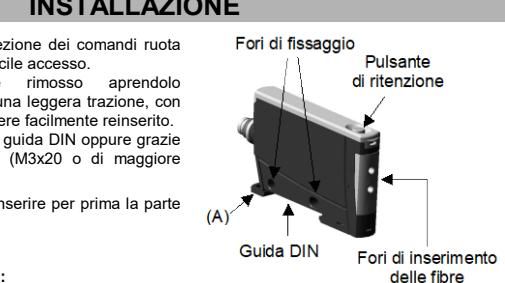
Per installazione su guida DIN inserire per prima la parte (A).
