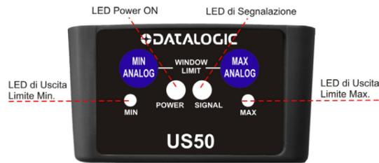
LED POWER ON (Verde) – Indica lo stato operativo del sensore.
