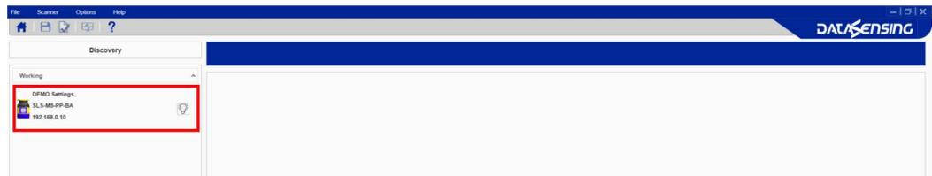
2. Hacer clic en el dispositivo localizado para introducirlo en el panel Configuración Dispositivo. Se visualizará un aviso que indica que el dispositivo no se encuentra en la misma red y que solicita alineación a la red.
