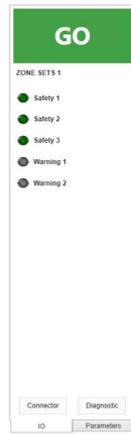
En el panel inferior izquierdo, DL Sentinel muestra el estado del dispositivo (si funciona correctamente). Además, es posible visualizar algunos parámetros, p. ej. la asignación de los pines y el tiempo de respuesta. Los ledes virtuales de las zonas configuradas (protección, alerta) responden al comportamiento de los ledes virtuales mostrados en la pantalla del dispositivo (para información detallada, consultar el Manual de instrucciones).
