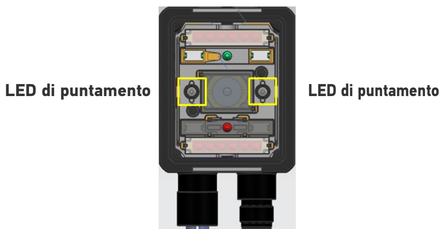
Figura 7 - LED di puntamento Smart-VS Plus
